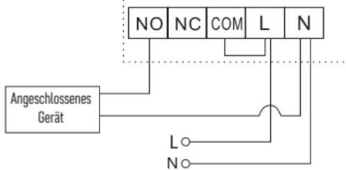
**Anschlussschema für den Kessel**
