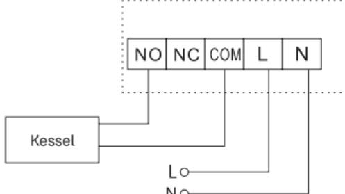
Das vorinstallierte Draht-Verbindungsteil wird nicht angeschlossen.
