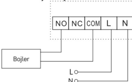
Unaprijed instalirana spojnica za žice neće biti spojena.
