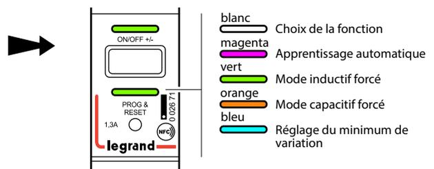
La validation se fait par un appui long sur le bouton PROG & RESET.
