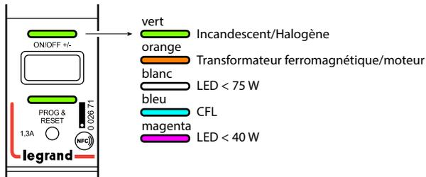
La validation de la charge choisie se fait par un appui long sur le bouton poussoir, la LED poussoir se met à clignoter de la couleur de la charge choisie. On doit terminer cette étape par un appui long sur le bouton PROG & RESET, les 2 LEDs s'éteignent.
