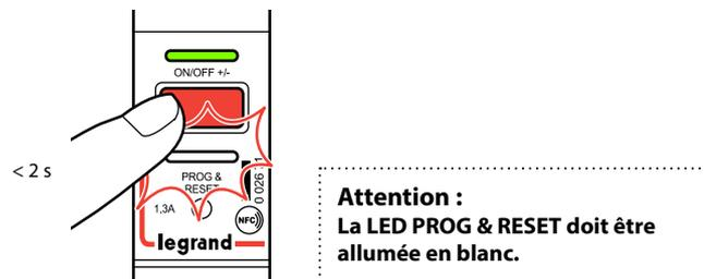
3 - La validation de la fonction choisie se fait par un appui long sur le bouton poussoir, la LED poussoir se met à clignoter de la couleur de la fonction choisie. On doit terminer cette étape par un appui long sur le bouton PROG & RESET, les 2 LEDs s'éteignent.
