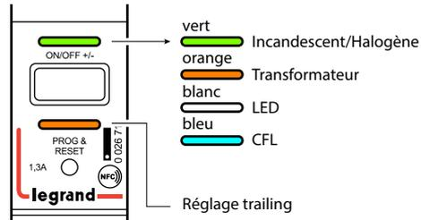
La validation de la charge choisie se fait par un appui long sur le bouton poussoir, la LED poussoir se met à clignoter de la couleur de la charge choisie. On doit terminer cette étape par un appui long sur le bouton PROG & RESET, les 2 LEDs s'éteignent.
