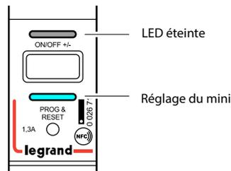
Le niveau souhaité pourra être ajusté avec des appuis longs sur la commande située dans la pièce. Un appui long sur le bouton poussoir (ON/OFF) du téléviateur permet de sauvegarder le niveau minimum réglé.
