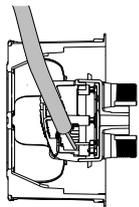
La connexion arrière limite la déformation du câble coaxial, évitant une rupture d'impédance et préserve donc les performances.
