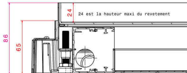
Hauteur béton mini 65 si revêtement ( carrelage + colle) > à 21 mm.
