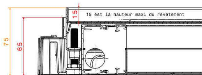
Hauteur béton mini 65 si revêtement ( carrelage + colle) > à 10mm.
