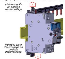
Tirer l'appareil vers l'avant afin de le dégager du rail
