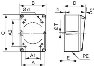
A1 и A2 : дополнительные точки крепления, закрываемые крышкой. Металлические коробки оснащены следующими компонентами:
