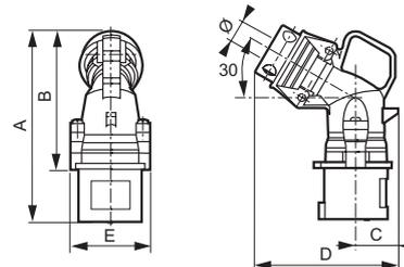
Угловые вилки со степенью защиты IP 44 для цепей НН на ток 63 А
