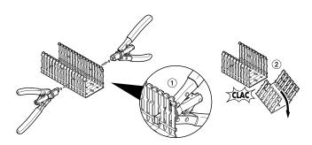
Elles permettent de réaliser une jonction en T entre une goulotte verticale et horizontale sur toute la hauteur, sans obstacle. Après découpes avec la pince Lina 25, la partie latérale se détache facilement grâce à l'amorce de rupture en pied de goulotte.
