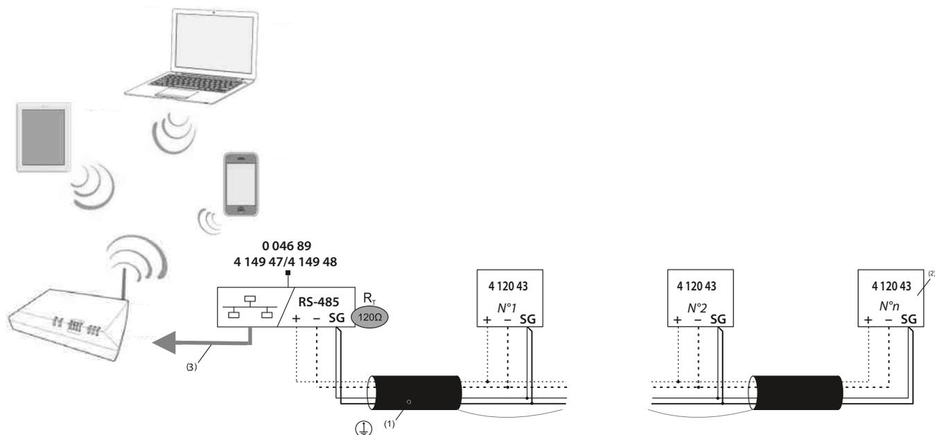
(1) RS485: Utilisation prescrite de câble Belden 9842, Belden 3106A (ou équivalent) pour une longueur maximum du bus de 1000 m ou de câble de Catégorie 6 (FTP ou UTP) pour une longueur maximum de 50 m.
