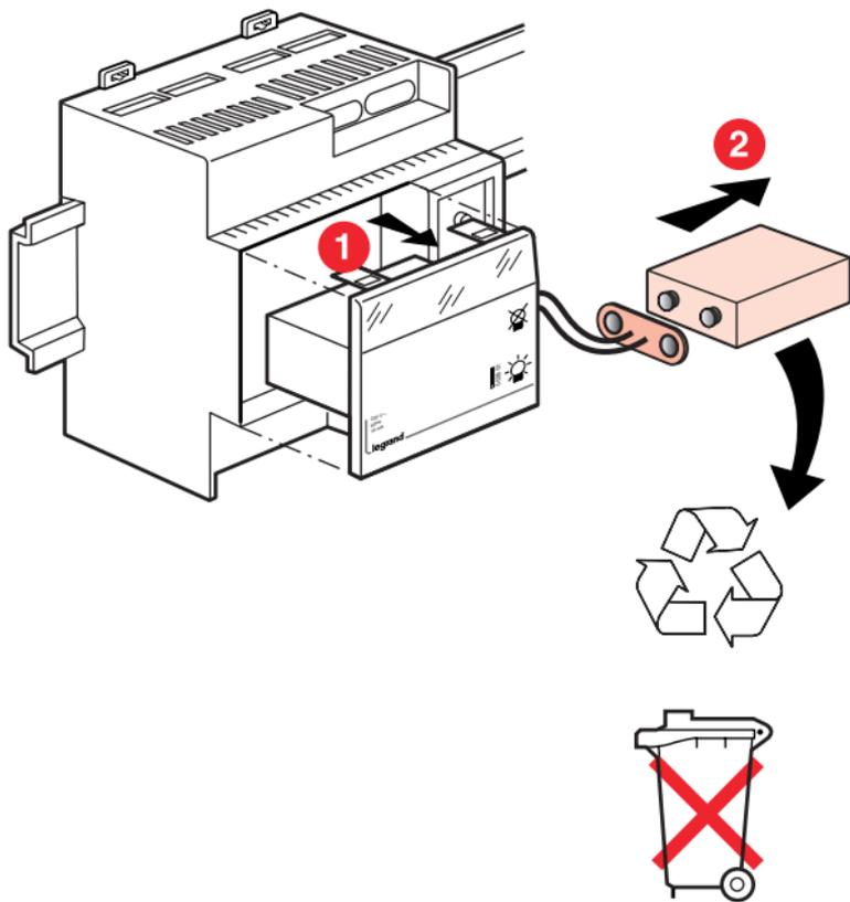
Certains modèles d'accumulateurs qui équipent cette télécommande contiennent du cadmium ( batterie Ni-Cd ) pouvant être dangereux pour l'environnement. Les distributeurs partenaires LEGRAND reprennent ces accumulateurs usagés.
