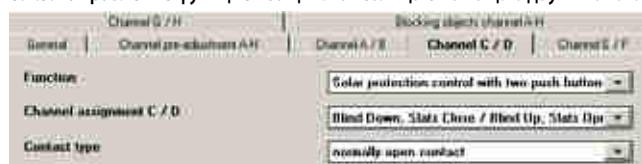
С помощью пары кнопок можно снизить или повысить защиту от солнца до требуемого уровня длительным нажатием; кратковременное нажатие останавливает или приводит в движение жалюзи на один шаг. Чтобы определить, какая кнопка (или канал) используется для снижения/повышения уровня защиты от солнца и закрывает/открывает жалюзи на один шаг, можно выполнить соответствующие настройки.
