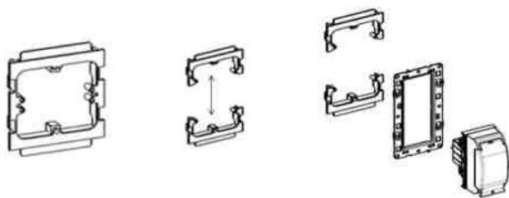
Support pour montage appareillage Arteur ou Mosaic 4, 5, 6, 7 et 8 modules Arteur ou Mosaic et appareillage Belanko.
