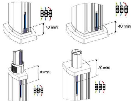
L'arrivée des câbles peut être réalisée par le sol, via faux plancher/ passage de plancher, ou par le plafond.
