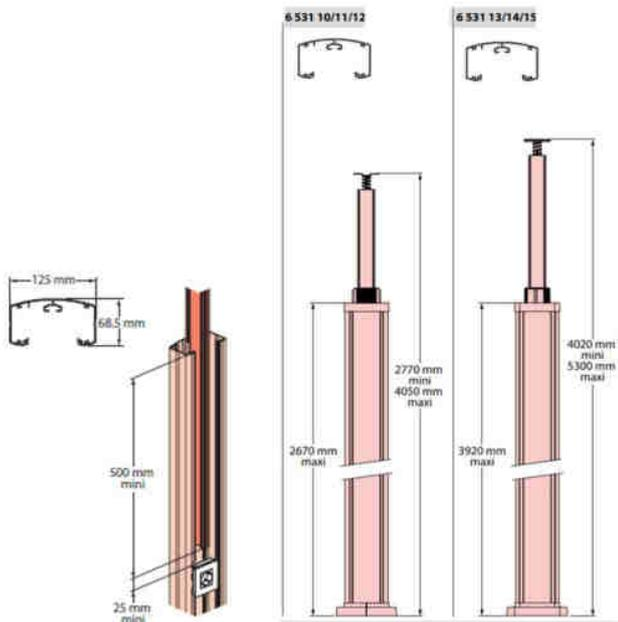
Entraxes de fixation au sol des platines
