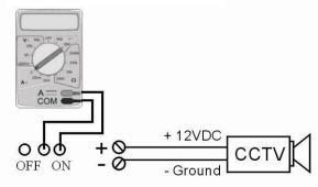
Měření provádíme dle schematu zapojení
