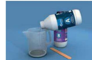
Do odměrky (součást balení) odlijeme požadované množství gelové hmoty A a gelové hmoty B (v poměru 1:1).
