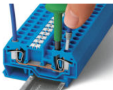
Připojení CAGE CLAMP® Připojení vodiče. Při použití jmenovitých průřezů s dutinkami je nutné zvolit vždy nejbližší větší svorku.
