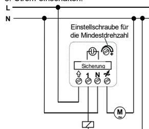
Über die Klemmen 1 und N kann der Drehzahlsteller durch eine Sicherungseinheit mit Glühlampe beleuchtet werden (im Lieferumfang enthalten oder nachrüstbar). Nur wenn der Drehzahlsteller beleuchtet werden soll ist der Anschluß des Neutralleiters (N) erforderlich.
