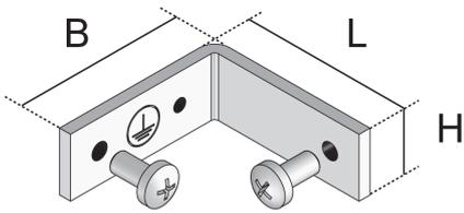
Bei den Produktlösungen UEBSVE S handelt es sich um drehbare Eckverbinder für estrichbündige Kanäle. Die Verbinder dienen dem montageseitigen Erstellen eines Formteiles. Dabei sind sie, je nach Drehrichtung, als Innen- oder Außeneck einsetzbar. Die Bauelemente sind aus sendzimir-feuerverzinktem Stahlblech nach DIN EN 10346 gefertigt und in einer Höhe von 16 mm, einer Breite und Länge von 43 mm und inklusive zweier Linsenkopfschrauben LKS M5X10 erhältlich.
