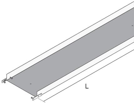
Bei den Montagekomponenten UEBMSW handelt es sich um Bodenwannen für estrichbündige Kanalsysteme. Diese Bauteile werden aus sendzimir-feuerverzinktem Stahlblech nach DIN EN 10346 gefertigt und sind in einer Einbauhöhe von 60 bis 120 mm, einer Breite von 200 bis 500 mm, einem Nivellierbereich von 30 mm und einem Längenmaß von 2000 mm erhältlich.
