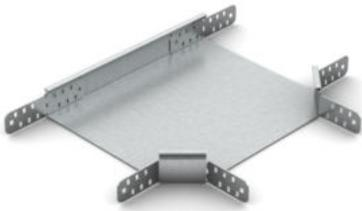
Der Kabelrinnen-Abzweig RA 60 ermöglicht horizontale Richtungsänderungen der Kabelführung in Form eines Abzweigs. Er wird zwischen zwei Kabelrinnen eingesetzt und ermöglicht den Anschluss einer weiteren Kabelrinne im rechten Winkel. Der Kabelrinnen-Abzweig eignet sich für Kabelrinnen mit Seitenhöhen von 60 mm. Verschiedene Materialien und Oberflächen sorgen dafür, dass die Korrosionsanforderungen unterschiedlichster Anwendungsgebiete erfüllt werden.
