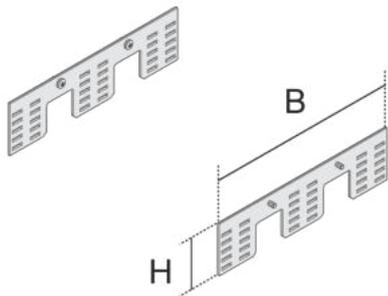
Bei den Bauelementen UGEAV handelt es sich um Rastleitersets für eckige Edelstahlseinheiten. Die Rastleitern lassen sich an die Rahmen der Niveleereinheiten UNE für viereckige Edelstahlkassetten mit Kabel- bzw. Tubusauslass schrauben. Die Kassetten können anschließend mit bis zu drei Gerätebechern für Installationsgeräte bestückt werden. Die Rastleitersets sind aus sendzimir-feuerverzinktem Stahl (DIN EN 10346) gefertigt.
