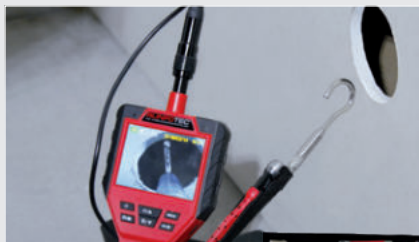
Inspekce dutých stěn Hledání a zachycení
