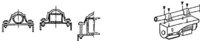
Konstrukcja nośna zapewnia bezpieczne zamocowanie strzemion nośnych i zapewnia ruch lub przesunięcie wciągnika. Konstrukcja powinna być również w stanie wytrzymać działania statyczne i dynamiczne występujące podczas manipulowania narzędziem.
