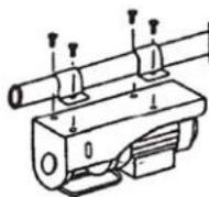
Nosná konstrukce musí zajišťovat bezpečné upevnění nosných třmenů a vyličovat pohyb nebo vyosení navijáku. Dále musí být nosná konstrukce schopna vydržet působení statických a dynamických sil vznikajících za provozu navijáku.
