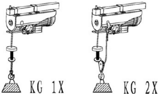
Nosnost lanového navijáku lze zdvojnásobit použitím volné kladky. Mějte na paměti, že se pracovní délka lana sníží na polovinu. Potřebujete-li použít volnou kladku, postupujte následujícím způsobem.
