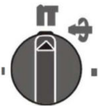
Wiercenie udarowe- beton i kamień
