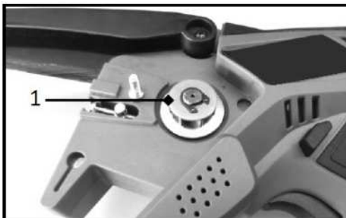
1. Wałek zębaty; 2. Elementy sprawdzone pod kątem zużycia
