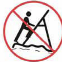
Postavení žebříku na vodorovném podkladu
