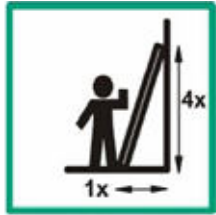
Vhodný úhel postavení žebříku
