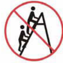
Pouze jedna osoba na výstupním rameni žebříku / příčkového žebříku
