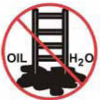
Zabezpečiť, aby bol podklad bez nečistôt
