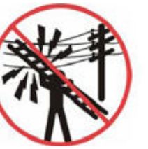
Uvědomit si nebezpečí elektrického původu při přenášení žebříku
