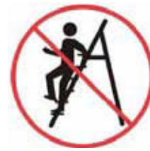
Při nastupování a vystupování být vždy obrácen tváří k žebříku
