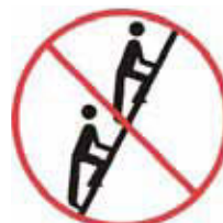
Iba jedna osoba na výstupnom ramene rebríku / priečkového rebríka
