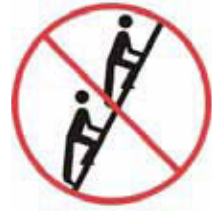
Pouze jedna osoba na výstupním rameni žebříku / příčkového žebříku
