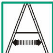
Zabezpečiť, aby dvojitý rebrík bol pred použitím vždy úplne roztvorený
