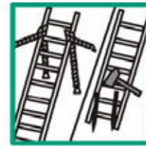
Zajistit horní / dolní konec žebříku
