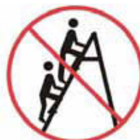
Iba jedna osoba na výstupnom ramene rebríku / priečkového rebríka
