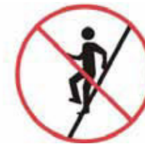
Při nastupování a vystupování být vždy obrácen tváří k žebříku
