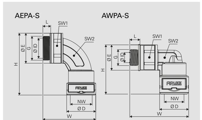
**Montagehinweis:** Wellrohr mit leichter Drehbewegung bis zum Anschlag in die Verschraubung einstoßen. Durch anschließend leichtes Zurückziehen wird die Verriegelung optimal positioniert. Wir empfehlen das Wellrohr im Wellental zu schneiden, um so den bestmöglichen Schutz zu gewährleisten.
