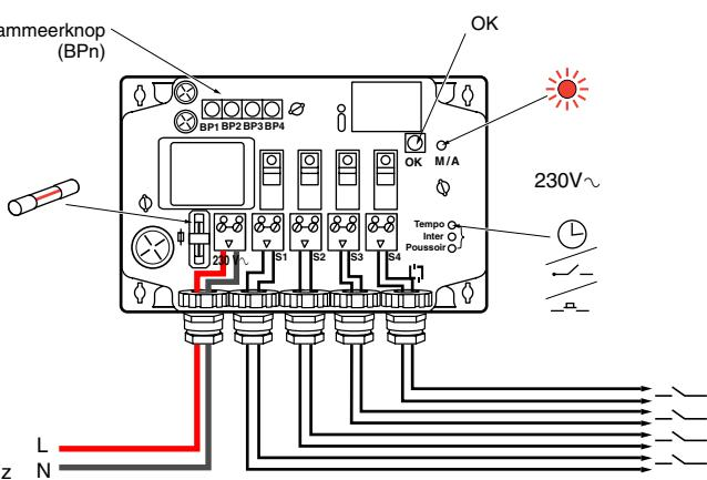
Dit product kan 16 aanschakelcodes en 16 uitschakelcodes memoriseren die verschillend zijn per uitgang. De werkwijzen kunnen echter niet gemengd worden. De werkwijze met Temporisatie, Schakelaar of Drukknop zal identiek zijn voor alle gememoriseerde codes per uitgang.
