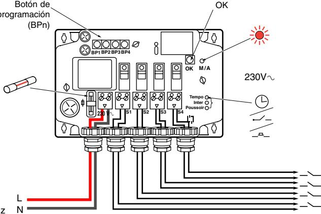
Este producto puede memorizar 16 códigos de Encendido y 16 de Apagado distintos por salida. No obstante, no es posible mezclar los modos de funcionamiento. El modo de funcionamiento, Temporización, Interruptor o Pulsador, será idéntico para todos los códigos memorizados en una misma salida.
