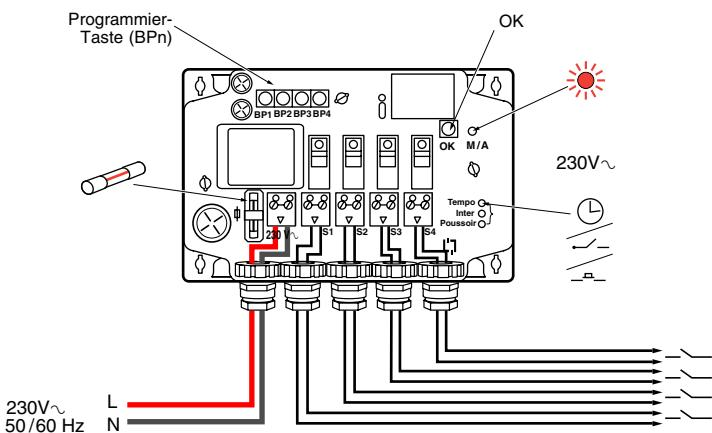
Mit diesem Gerät können Sie pro Ausgang 16 Einschaltcodes und 16 Ausschaltcodes speichern.
