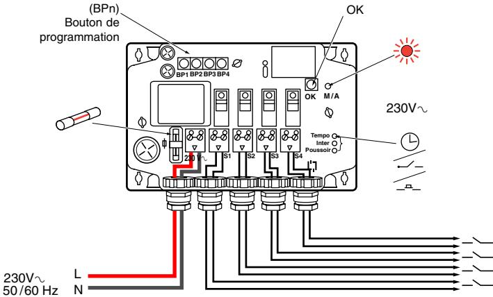
Ce produit peut mémoriser 16 codes Allumage et 16 codes Extinction différents par sortie. Cependant, le panachage du mode de fonctionnement n'est pas possible. Le mode de fonctionnement Temporisation, Interrupteur ou Poussoir sera identique pour tous les codes mémorisés sur une sortie.
