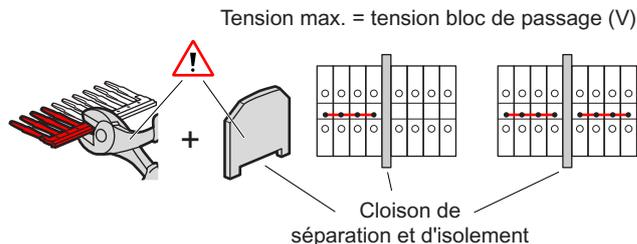
En configuration liaison alternée, il y a déclassement de tension :
