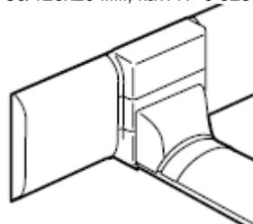
Обеспечивает соединение плинтуса 80/120x20 с напольным кабель-каналом кат. № 0 328 00.
