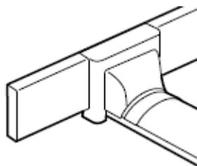
Обеспечивает соединение плинтуса размером 60x20/75x20 мм с напольным кабель-каналом кат. № 0 328 00.
