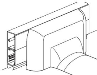
Позволяет соединить кабель-канал DLP с напольным кабель-каналом, кат. № 0 328 00.
