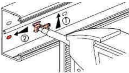
Attention pour fixation en hauteur 65mm, il faut incliner l'appareil.
