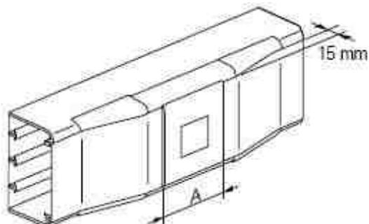
Permet d'augmenter de 15mm la hauteur d'un profilé pour conserver l'espace de câblage lors d'une dérivation plane ou lors de la pose d'un support appareillage.
