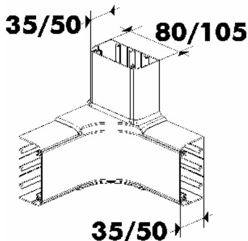
Permet la dérivation dans un angle intérieur sur mur droite ou gauche vers les goulottes 35x80, 35x105, 50x80 ou 50x105 mm. Respect de l'indice de protection. Améliore l'esthétique (recouvrement de la coupe) Montage sur le corps de la goutte par clipsage Coloris blanc
