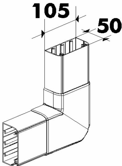
Permet la jonction en angle plat de deux morceaux de goulottes de même section :
