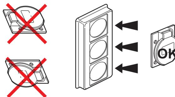
Contrairement aux socles IEC, les socles P17 (576 71, 576 72 et 576 76) à brochage domestique doivent être fixés verticalement sur le plastron 577 14.
