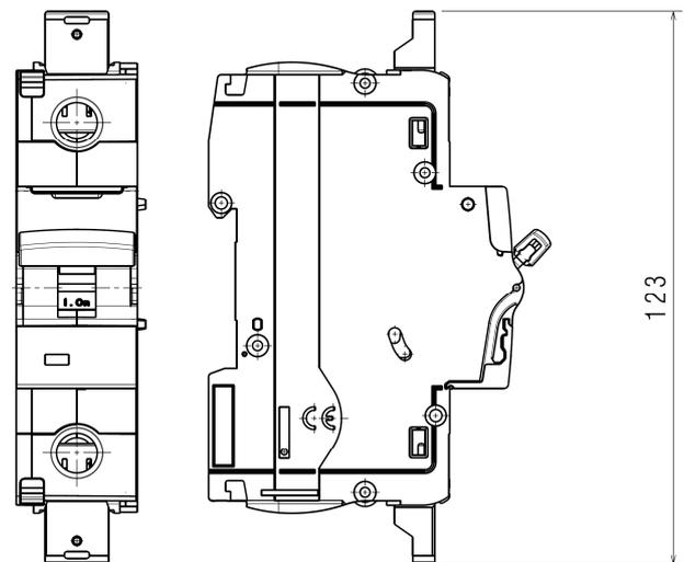
Максимальная высота модульного автоматического выключателя с крышкой винтовых выводов меньше высоты с поднятыми встроенными изолирующими межполюсными перегородками (126 мм).
