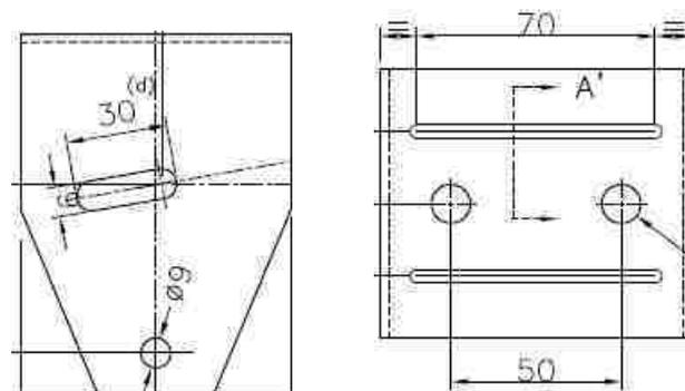
Pour la fixation des profilés U métal époxy sur les goussets ; utiliser des vis M8x20
