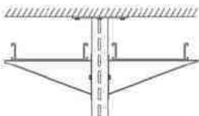
Au delà de 67 daN mesuré sur un même côté, répartition des charges de chaque côté du pendard jusqu'à 310 daN maxi
