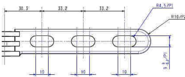
Fixation avec boulon M8 ; trous oblongs 9x18mm, entraxe 33.2mm
