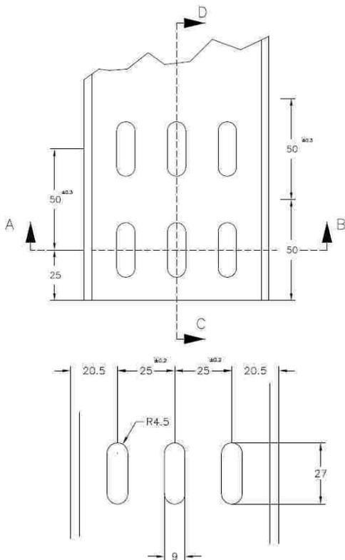
Pour la fixation des rails sur les goussets ; utiliser des vis M8x20
