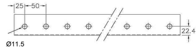
Pour la fixation des rails sur les goussets ; utiliser des vis M8x20
