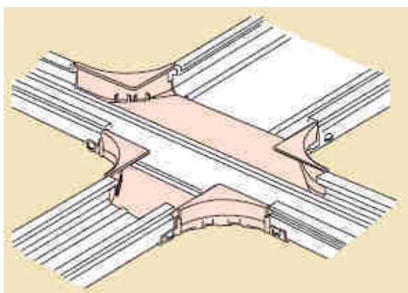
L'assemblage de la pièce de jonction avec la plaque de fond se fait ici à l'aide des pattes de fixation
