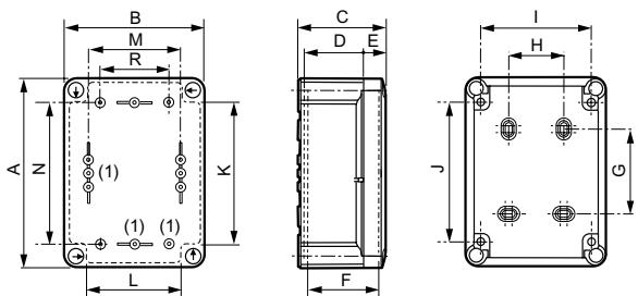
(1) Points de fixation en fond de boîtier pour rail et plaque de montage
