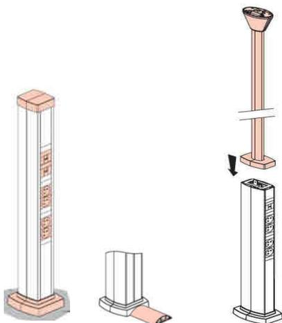
Installation compatible avec les passages de plancher
