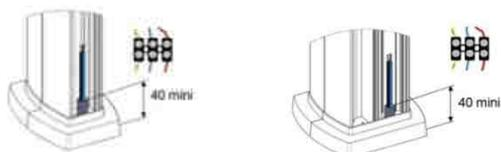
L'arrivée des câbles peut être réalisée par le sol, via faux plancher/
