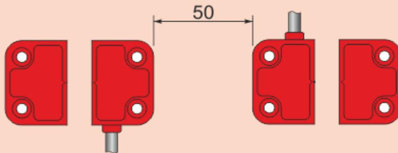
**N.B.** La distanza minima fra sistemi *sensore-azionatore* deve essere almeno 50mm.
