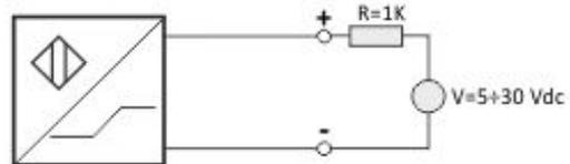
In assenza dell'azionatore metallico  $I \geq 3\text{mA}@8.2\text{V}$
