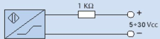
In assenza di metallo  $I \geq 3 \text{ mA} @ 8.2 \text{ V}$
