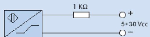
I sensori NAMUR sono rivelatori elettronici la cui corrente assorbita viene modificata dall'avvicinarsi di un oggetto metallico. La differenza dai rilevatori tradizionali consiste nell'assenza degli stadi trigger e dell'amplificatore.
