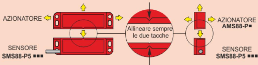
**N.B.** La distanza minima fra sistemi  *sensore-azionatore*  deve essere almeno 50mm.
