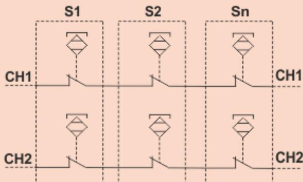
E' possibile collegare in serie più sensori magnetici di sicurezza al modulo **MS-ER MA R01** ■ . La resistenza totale dei sensori e dei cavi non deve superare la resistenza di ingresso per canale del modulo di sicurezza. Con questa tecnica si possono realizzare circuiti di sicurezza al massimo in categoria 3 secondo EN ISO 13849-1.
