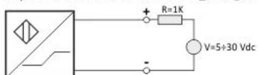
In assenza dell'azionatore metallico  $I \geq 3\text{mA}@8.2\text{V}$
