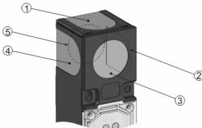
N.B.: Nel sensore SIP40 l'oscillatore è alloggiato in un modulo ad incastro e la superficie attiva può assumere cinque diverse posizioni a seconda delle necessità e può essere evidenziata esternamente con apposita etichetta fornita a corredo
