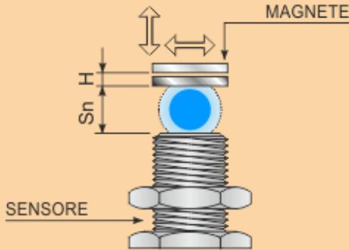
**Sn:** distanza di intervento in funzione del tipo di magnete usato
