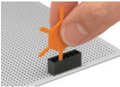
Kódování konektoru do plošného spoje (vidlice) zasunutím kódovacího kolíku.
