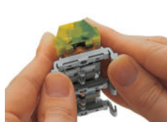
Svorkovnice se západkami Naklapnutí montážní patky (209-120). (Vzdálenost mezi montážními patkami: cca 25–30 mm.)
