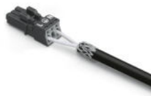
Stínění přehněte přes plášť kabelu. Délka odstraněného pláště = 30 mm Délka stínění = 8 mm
