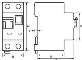
Maßzeichnung FI-/LS-Kombinationen DRCBO 3 Typ AC, C-Charakteristik, 1+N-polig
