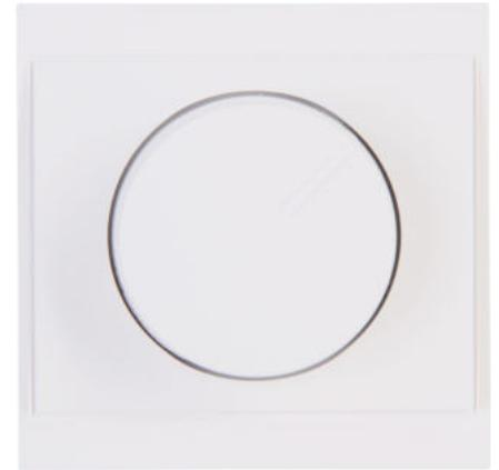
Elektronischer Dimmer mit Druck-Wechselschalter (Phasenabschnitt) im Design MALTA und der Farbe arktisweiß für elektronische Transformatoren für Glüh- und 230V-Halogen-, sowie Niedervolt-Halogenlampen mit dimmbaren elektronischen Trafos. Nicht für konventionelle Trafos, 20-325W/VA, 230V~, 50Hz, technische Angaben der Trafo-Hersteller beachten, Schutzart IP20
