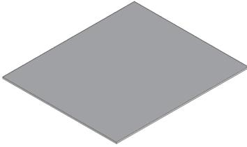
Bei den Produktlösungen UEK V handelt es sich um viereckige Deckeinlagen aus dem Portfolio der Unterflurssysteme. Die Montageelemente werden in eckige Kunststoff-Klappdeckeinheiten eingesetzt, um dort Bodenbelagsaussparungen zu verringern. Die Deckeinlagen werden aus Karton oder aus Polyvinylchlorid gefertigt. Beide Modelle sind 210 mm breit und 243 mm lang.
