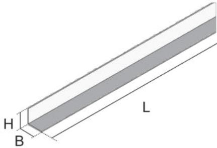
Bei den Bauelementen UEBSTR handelt es sich um Trennstege für estrichbündige Kanalsysteme. Sie werden in die Kanäle verschraubt und dienen dort zur sicheren räumlichen Trennung der Stromkabel von anderen Einbauelementen, wie zum Beispiel Datenträgern oder Gerätebechern. Die Produktlösungen werden aus dem Kunststoff Polyamid gefertigt und sind in einem Längenmaß von 2000 mm erhältlich.
